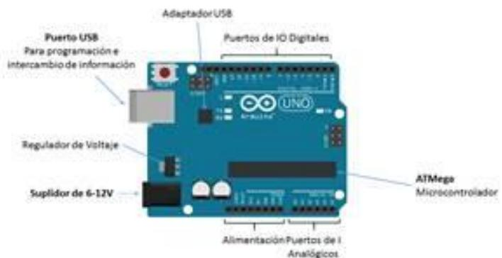
El *Arduino Uno* – R3 cuenta con un Micro controlador “ATmega328”, un voltaje de entrada de 7-12V, también un voltaje del sistema de de 5V. Su frecuencia de reloj es de 16MHz, su Digital 14 I/O. También cuenta con 6 entradas analógicas, 6 PWM, 1 UART. Su memoria Flash es de 32Kb; un cargador “Optiboot” y su interfaz de programación es USB vía ATmega16U2.
